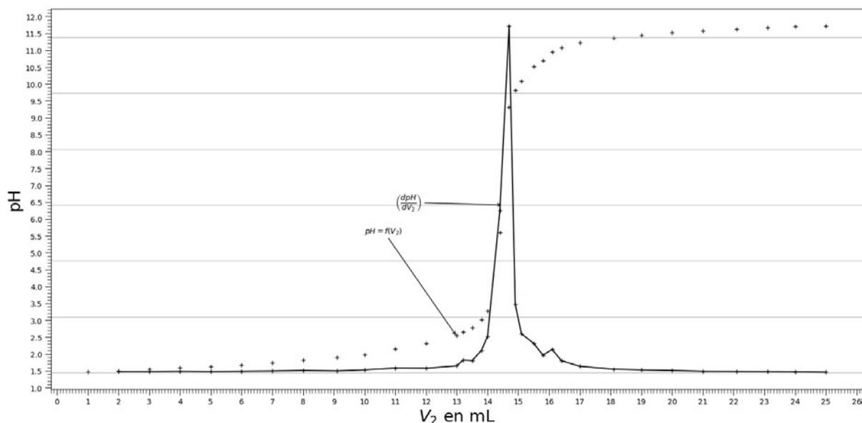
Figure 1. Courbe du dosage de la solution S<sub>1</sub> par la solution d'hydroxyde de sodium de concentration en quantité de matière c<sub>2</sub>
